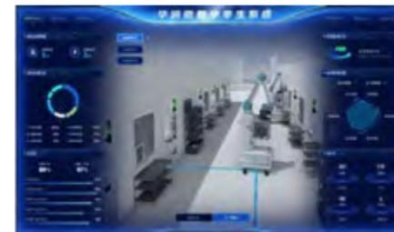
“数字孪生”技术是充分利用物理模型、传感器更新、运行历史等数据，集成多学科、多物理量、多尺度、多概率的仿真过程，在虚拟空间中完成映射，从而反映相对应实体装备的全生命周期过程。图为华润微电子数字孪生系统。
