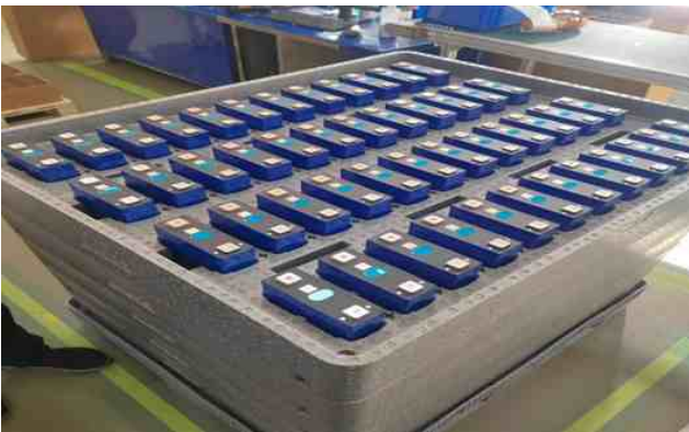
电芯的围板箱+EPP发泡方案
