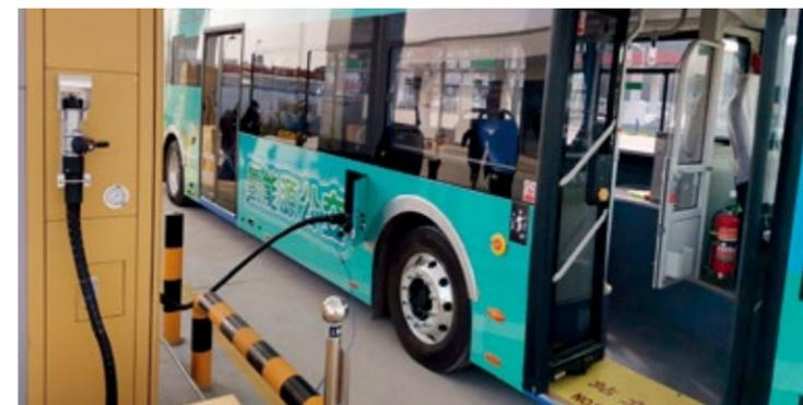
2020年12月14日，华润燃气首座纯加氢站——无锡华润燃气加氢站完成首次氢燃料电池车加氢测试，该加氢站一期加氢规模500公斤/天，可满足20-30辆氢燃料电池公交车加注需求
